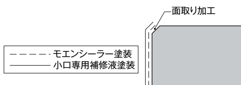
図4 モエン小口部の補修塗装
