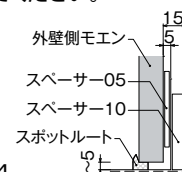
図4 通気金具工法の場合の縦断面図
