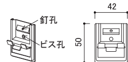
横張り用留付金具EX出隅用II (モエンス18:ハルモニアシリーズ以外用)
