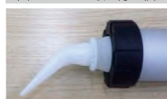
曲がりノズル取り付け後
