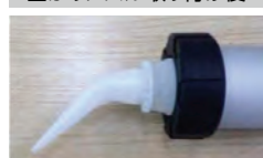
曲がりノズル取り付け後
