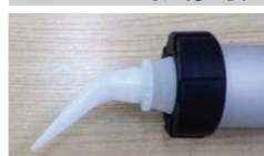
曲がりノズル取り付け後
