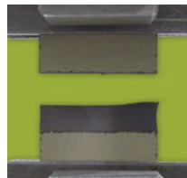
② 50°C湿度95%×2ヶ月養生後 (JISにない試験)
