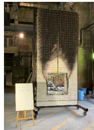
燃えひろがり試験の様子
