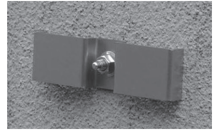
RC用アンカーを使用し、金属胴縁15アタッチメント (KN70) を固定してください。
