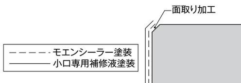
図4 モエン小口部の補修塗装
