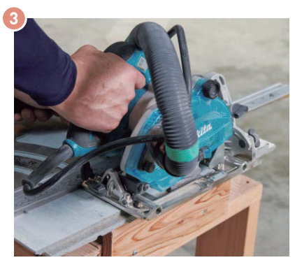
▲小型ミジキリで、モエン端部に合いじゃくり加工を施す
