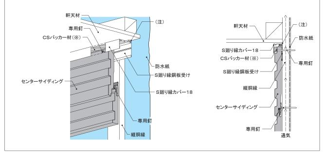
下 地 留付方法 張り方向 木胴縁組 NS型 縦胴縁 木造軸組下地 横 釘 @500mm以下
