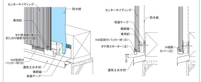
(注)降雪量の多い地域では鋼板製の部材を用いず、本体の芯材を取り除くかアルミ端部カバーを使用します。 なお、アルミ端部カバーを使用する場合、NS型段付バッカー材は不要です。
