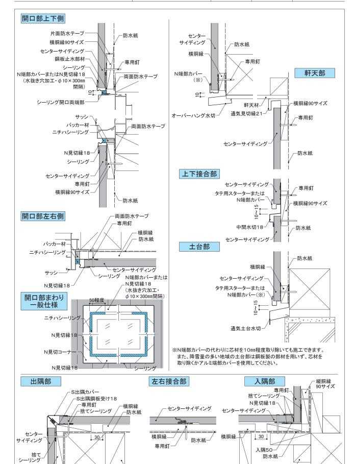
(注)FN型で45分準耐火構造が必用な場合、認定上、胴縁間隔は455mm以下となります。
