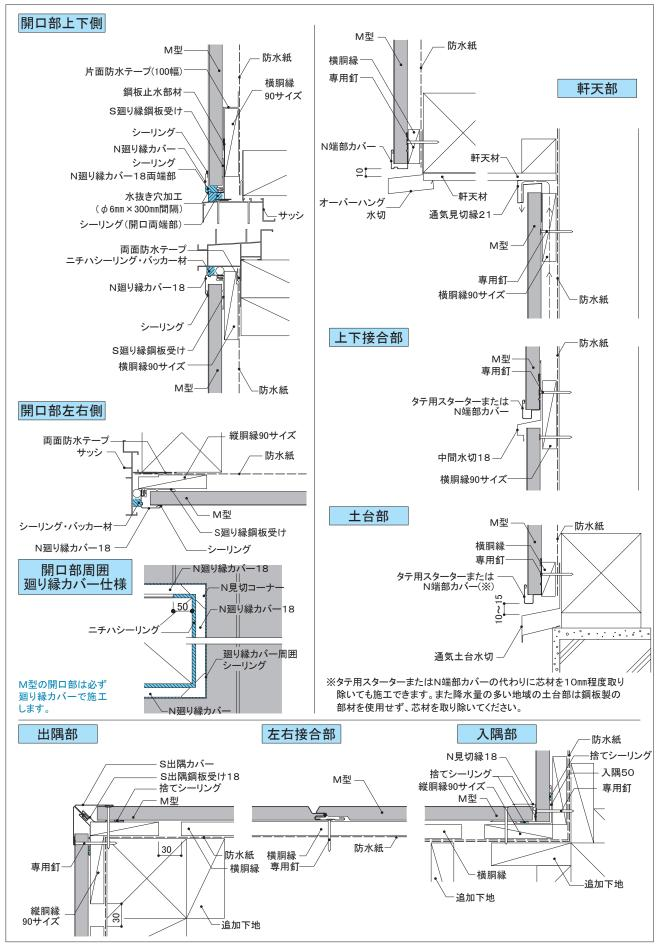
(注)上下接合部にアルミ端部カバー(積雪地向け)を使用すると防耐火構造認定の対象外となります。
