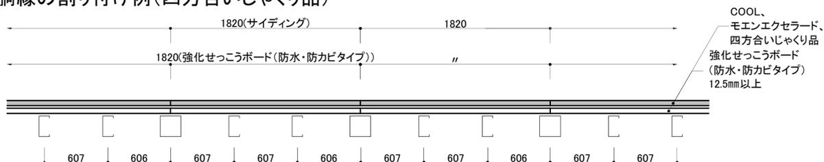
※強化せっこうボード(防水・防カビタイプ)は突き付け施工、サイディングは合いじゃくり接合で施工します。
