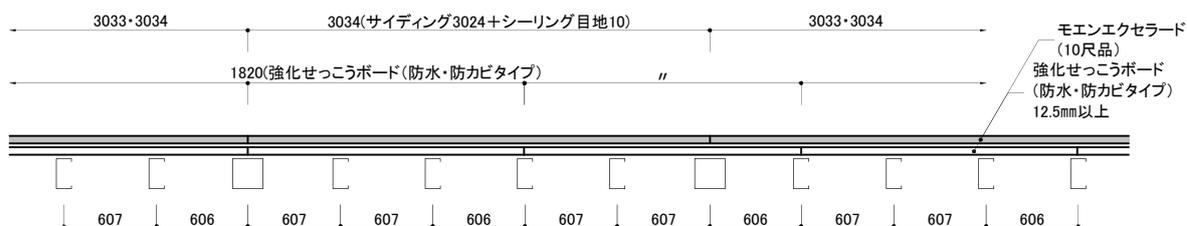
※強化せっこうボード(防水・防カビタイプ)は突き付け施工、サイディングは10mmのシーリング目地を設けて施工します。
