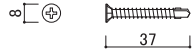
ステンレスリマテクスネジ 【品番:JK1520】 材質:ステンレス サイズ:φ4.5mm×37mm
