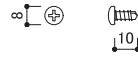
ステンステクスネジ 【品番:JK1510】 材質:ステンレス サイズ:φ4.5mm×10mm
