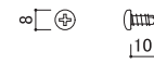
ステンレステクスネジ 【品番:JK1510】 材質:ステンレス サイズ:φ4.5mm×10mm
