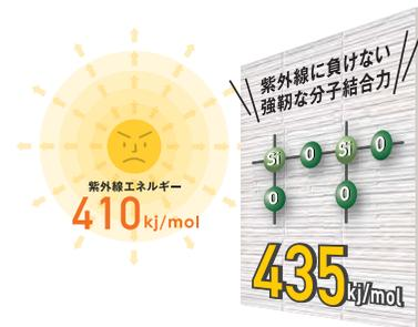
プラチナコートは、強い日差しや熱・雨などの過酷な自然環境を再現するサンシャインウェザーメーター試験で、18000hをクリア。色あせ・日焼けに強い超高耐候性を実現し、長期間にわたって美しい外観を維持します。
