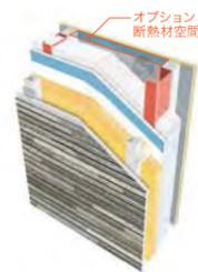
火災リスクの高い「発泡プラスチック系断熱材」は未使用!
