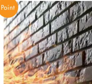
モエンエクセラードが窯業系サイディングでは世界初、オーストラリアの建築ファサードの燃えひろがり試験「AS5113」に合格。\*
