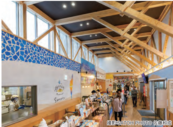
西棟のラウンジ。屋根の曲線が斜材の角度の変化に表れているそうです。
