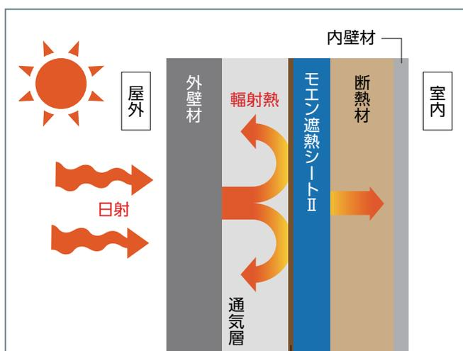
モエン遮熱シートⅡは表面のアルミ蒸着層が外壁から伝わる輻射熱を効果的に反射します。
