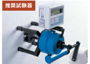
推奨試験器 サンコーテクノ株式会社 テクノテスターRT-2000LD(Ⅱ) (日本建築工上学会認定) ※アンカー・ビスの荷重確認については、弊社営業窓口までお問い合わせください。 写真は引張荷重確認試験の一例です。現場に応じた方法で確認を行ってください。
